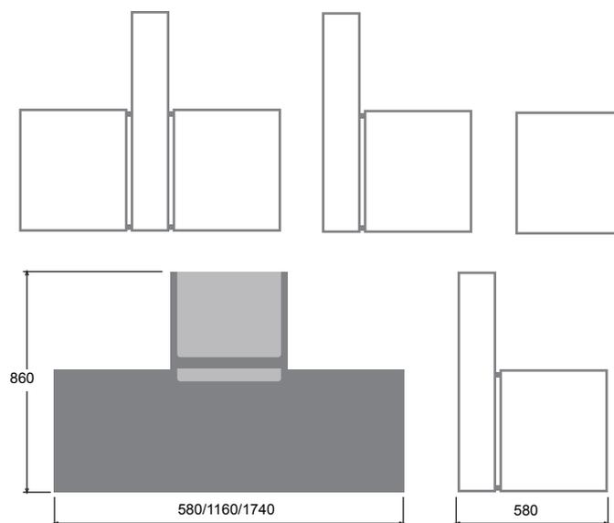
Sehr modular / Cortenstahl mit Elementen aus rostfreiem Stahl,
